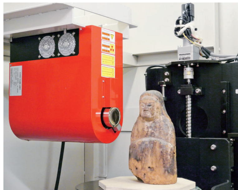
デバイスを更新したマイクロフォーカスX線CT装置による木彫神像の年輪年代調査 Dendrochronological research of a wooden statue of deity using the Microfocus X-ray system, exachnged for new source
